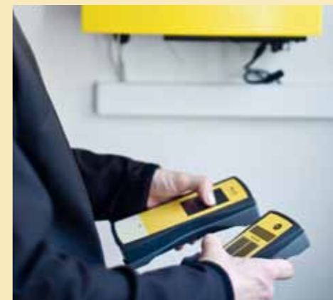
Transfert sans fil des valeurs mesurées depuis le TRI-SEN vers le TRI-KA.
