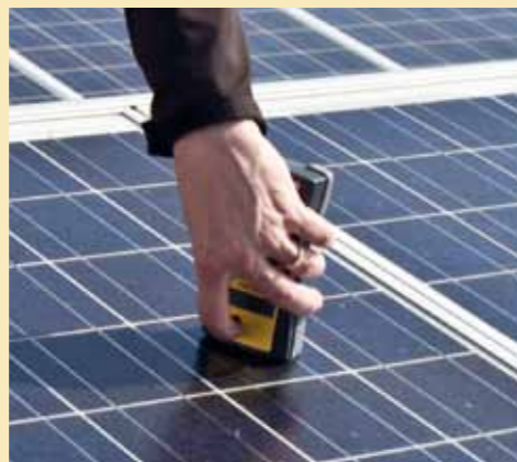
Mesurer la température superficielle des cellules au moyen du TRI-SEN.
