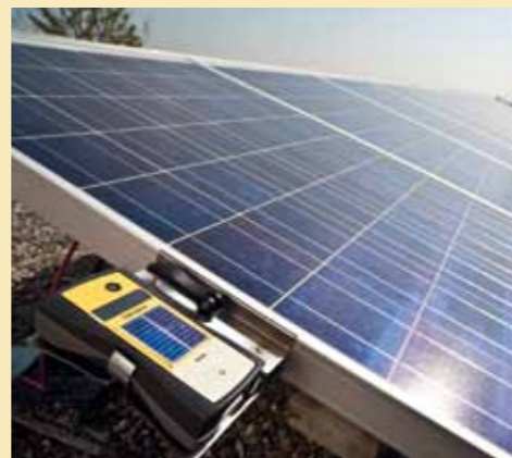
Positionner le TRI-SEN sur le même plan que les panneaux et mesurer le rayonnement solaire.
