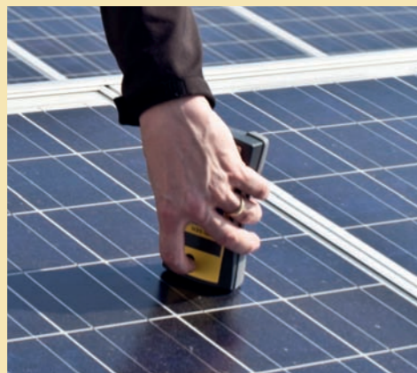
Mit dem TRI-SEN die Oberflächentemperatur der Zellen messen.
